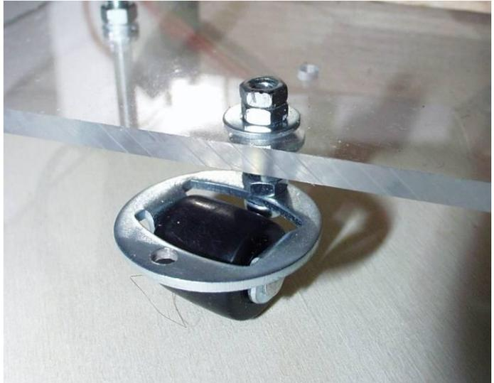
Diese Lagerung ist nicht so gut wie ein Kugellager. Sie funktioniert auf normalen Untergrund jedoch sehr gut.
