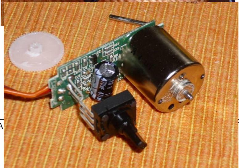
Der Potenziometer wird abgezwickelt.
