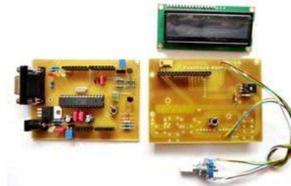
Version unterscheidet sich von den bisherigen in Bezug auf die Ansteuerung des Displays und die Verwendung von variablen Speed-Erkennungs-routinen. Wir benutzen die im OV schon bewährte Mikrocontroller-Plattform Arduino in der Version S3v3 Rev.2 und versehen sie mit einem von Reinhard entwickeltem Add-On – unserem "User Interface".
