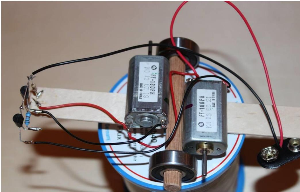
Es fehlt noch der Minusanschluss. Dazu wird der schwarze Draht des Batterieklips an die Spitze des 120 Ohm Widerstands gelötet.
